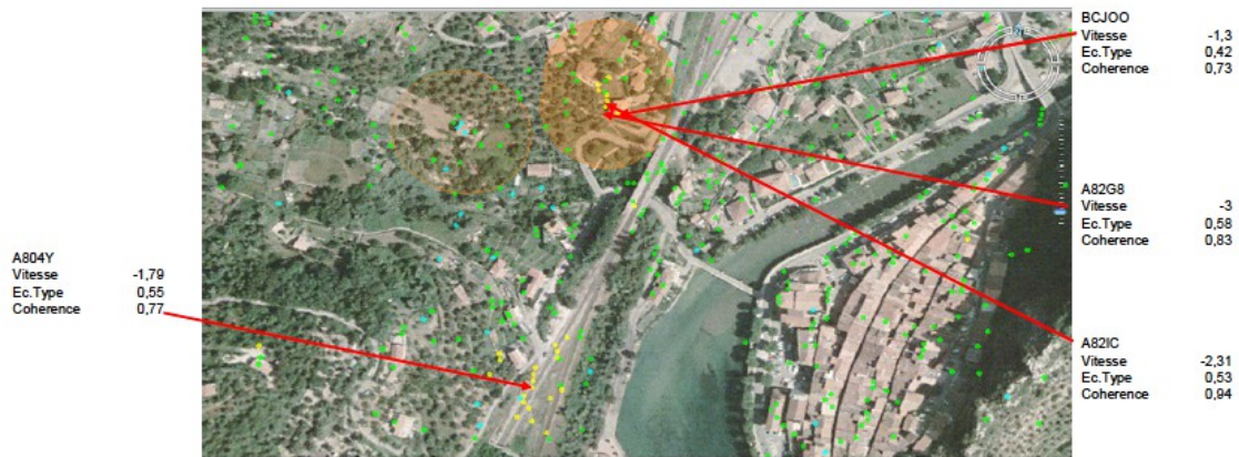
Cibles PS et vitesses moyennes (mm/an) autour de Breil-sur-Roya (ligne SNCF et Lavina)
