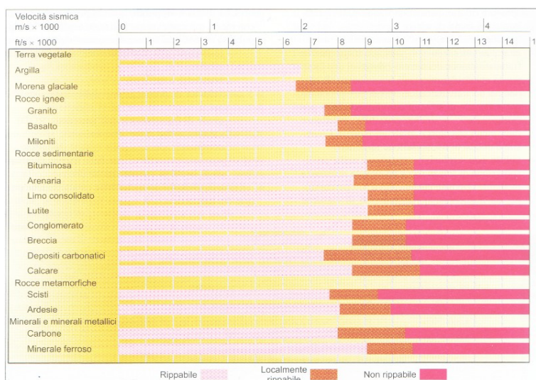
Condizioni di escavabilità in funzione del litotipo e della velocità di propagazione delle onde longitudinali
